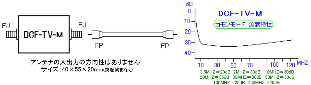
テレビジョン等と、フィルターまでの同軸ケーブルが長いとフィルターの効果が半減します、出来るだけテレビジョン等のアンテナ入力端子に直接取り付けして下さい
