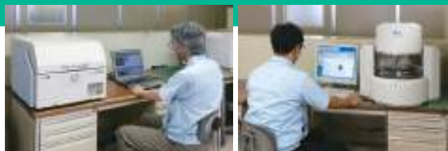
蛍光X線分析装置による有害物質チェック(部品、原材料のグリーン調達)
