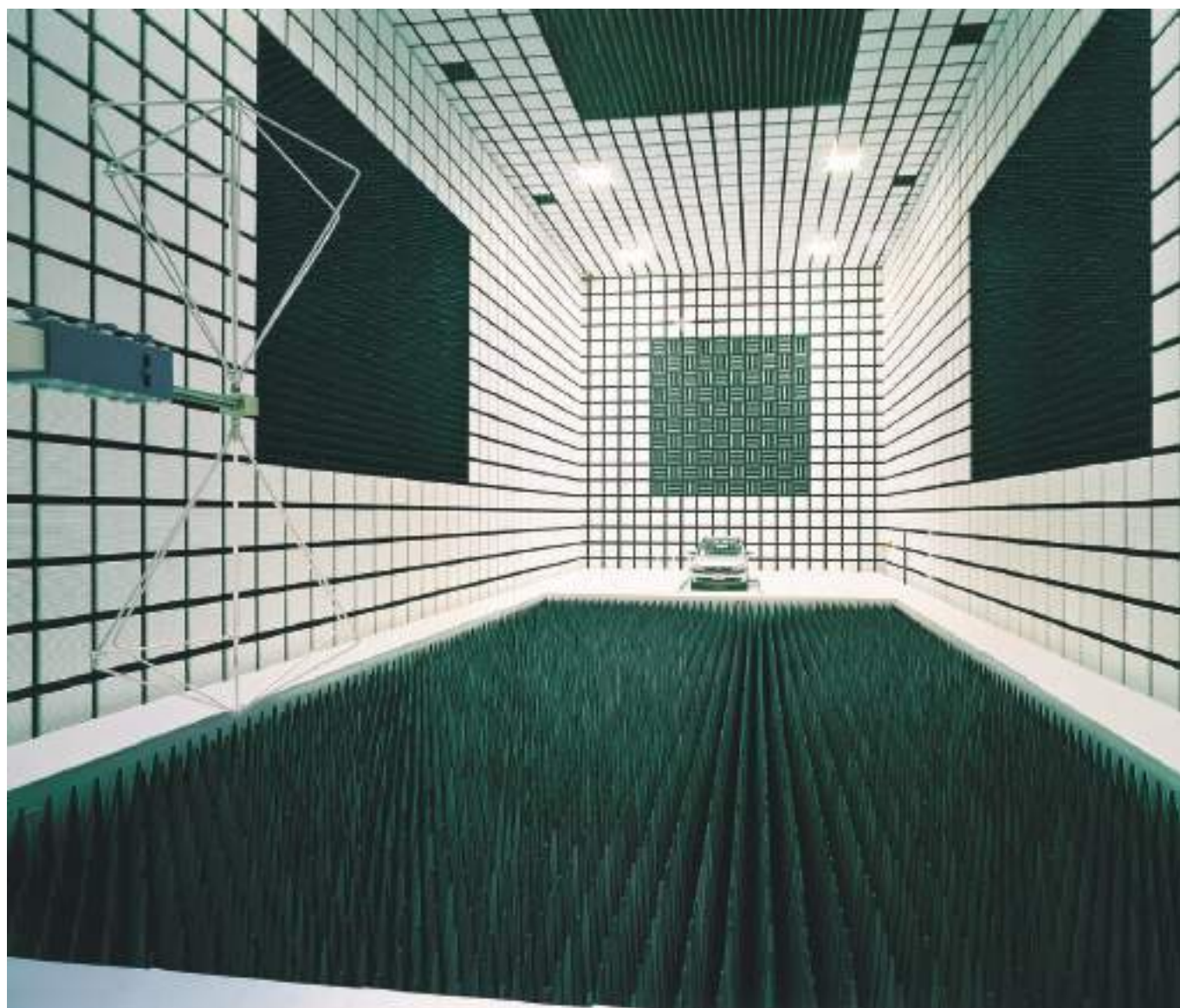
電波暗室／川里工場(埼玉県鴻巣市)にある日本最大級のアンテナ測定設備 ■建築床面積:760㎡ ■高さ:16m(空間内部:長さ30m×高さ14m×幅14m)
