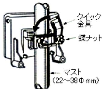
●U字ボルトのつけた金具は組み立てありますのでそのままケース裏側に差し込みます。ただし切れ込み部の方向を間違えないようにご注意ください。
