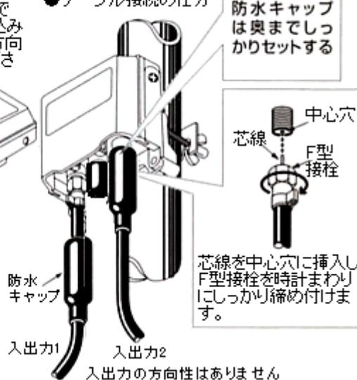
芯線を中心穴に挿入しF型接栓を時計まわりにしっかり締め付けます。
